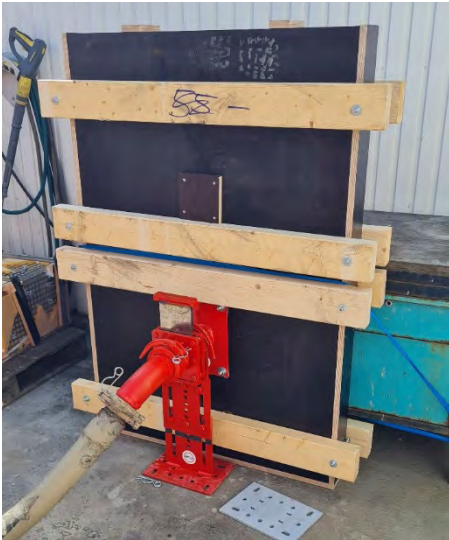
Abbildung 76: Schalung für Carbonbetonwand mit Pumpenanschluss (links), aufsteigender Beton in Schalung (rechts)
