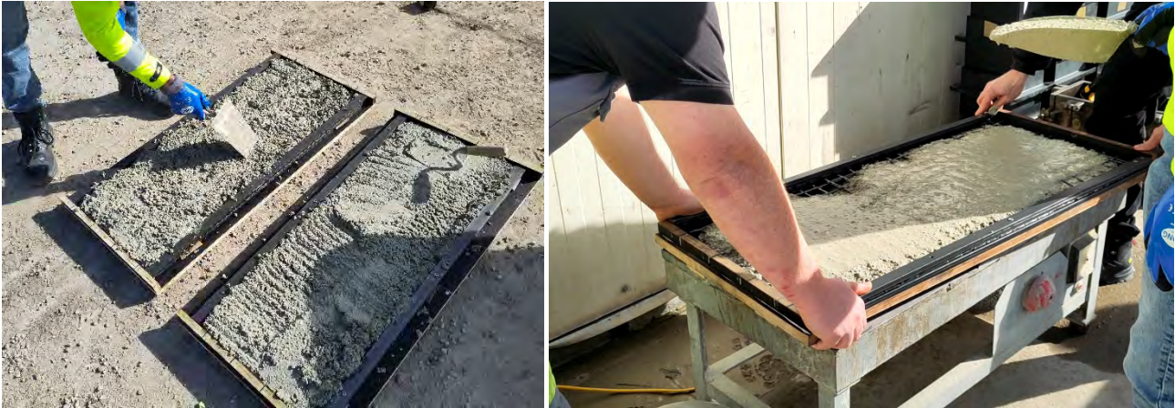
Abbildung 52: Befüllung und Verdichten auf dem Rütteltisch
