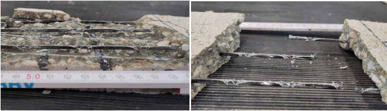
Abbildung 29: Versagensmodi für Textil 2 (links: Auszug/Spaltversagen; rechts: Textilriss)
