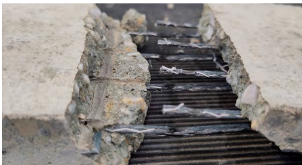
Abbildung 28: Versagensmodi für Textil 1 (links: Auszugversagen; rechts: Textilriss)
