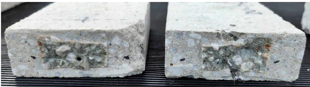
Abbildung 21: Querschnitt am Betonsteg eines geprüften SPO-Probekörpers (Auszug des Faserstrangs)
