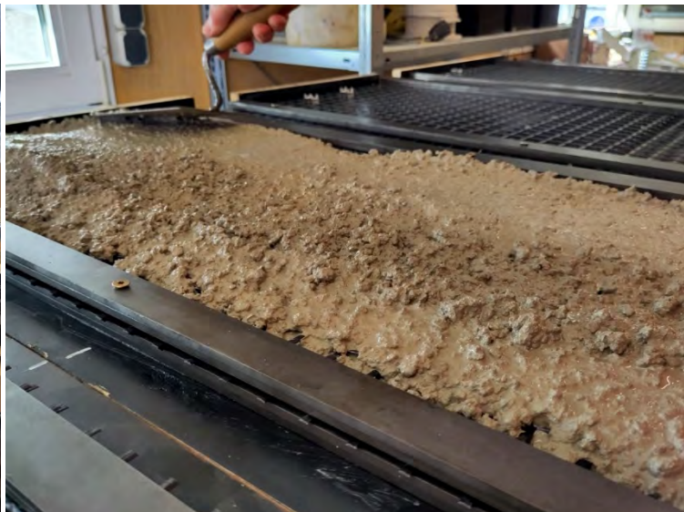
Abbildung 48: Herstellung der Probekörper im Transportwerk Schwenk - Dresden Hafen mit CEM III/B
