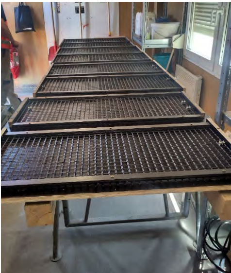
Abbildung 48: Herstellung der Probekörper im Transportwerk Schwenk - Dresden Hafen mit CEM III/B
