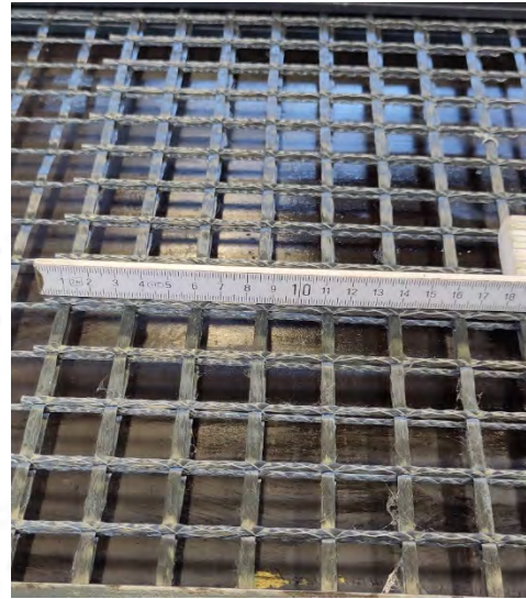
Abbildung 27: links: Probekörperaufbau für den Übergreifungsversuch; rechts: Textil 1 mit Übergreifungslänge von 200 mm
