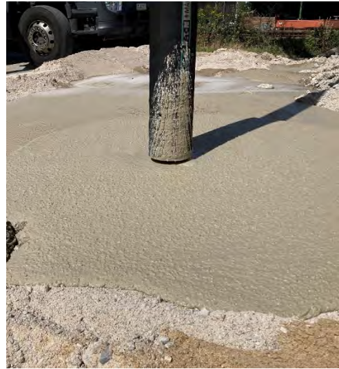
Abbildung 47: Pumpversuch beim Praxisversuch – Werk Hafen (Quelle: Schwenk / Sven Mellwitz)
