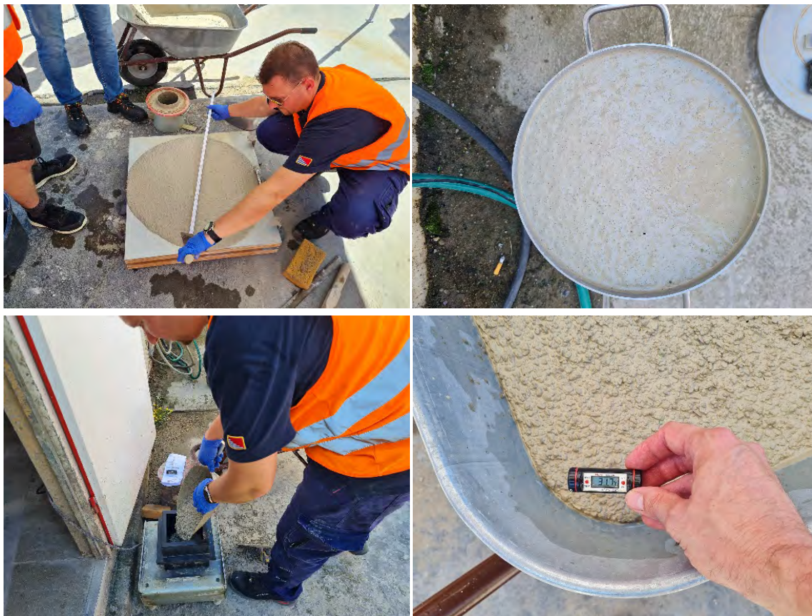
Abbildung 46: Praxisversuch – Werk Hafen; Betonprüfungen
