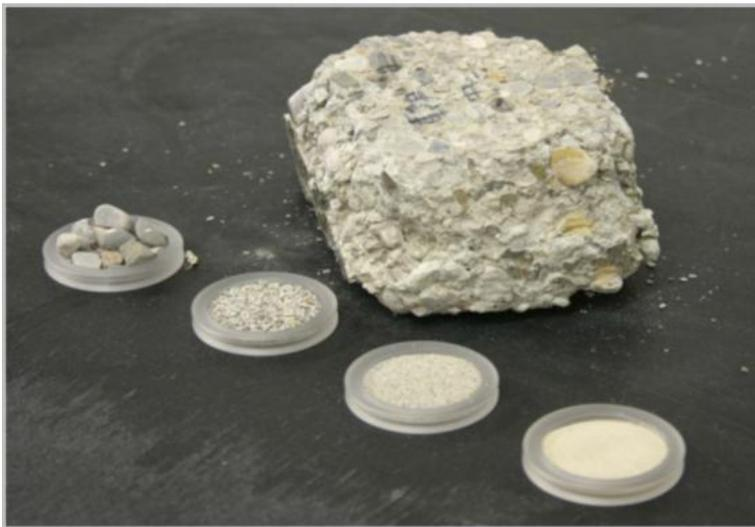
**Bild 6:** Altbeton vor und nach einer Fragmentierung /Tho12/
