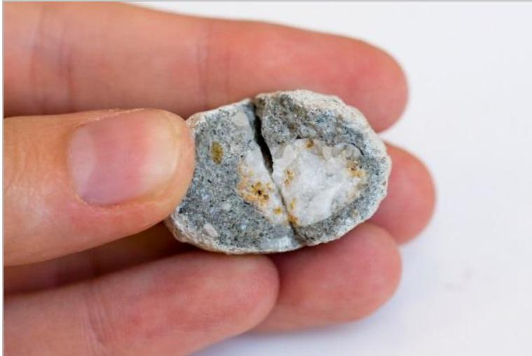
**Bild 14:** Betongranulat, mechanisch aufgebrochen (ibac)
