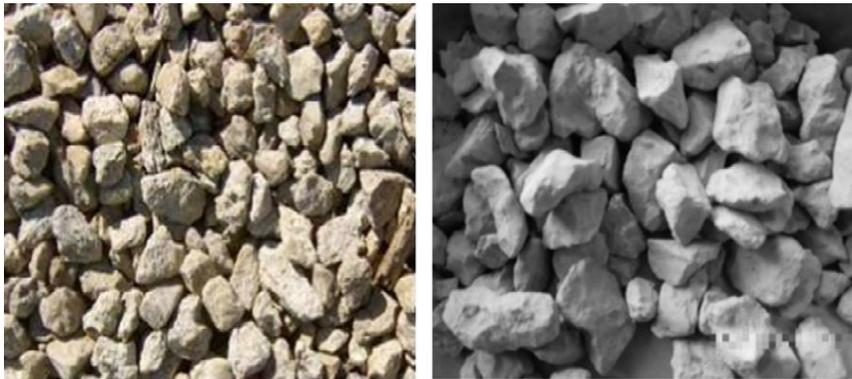
Bild 11: RC-Gesteinskörnung ohne (links) und mit einer Bindemittelleimbeschichtung (rechts) /Zhi13/
