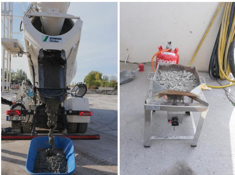
Abbildung 3.21: Probenahme im Rahmen der Praxisversuche Teil 2 (links) und Darrvorgang (rechts)
