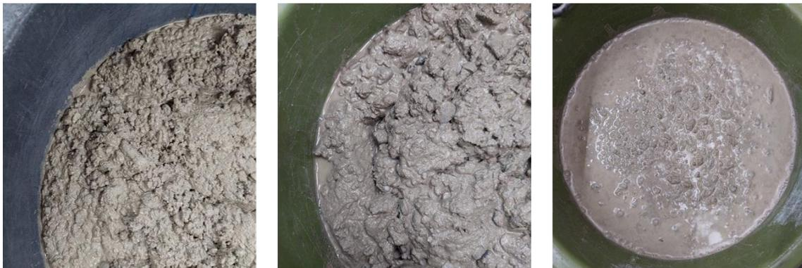
Abbildung 3.1: Problematik der Zusammensetzung des Referenzbetons 1; direkt nach Mischende (links); nach Messung Feuchtesonde 1 (Mitte) und nach erneuter Verdichtung, vor Messung Feuchtesonde 2 (rechts)
