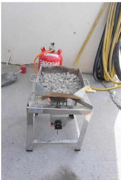
Abbildung 2.3: Bestimmung des Wassergehalts einer Frischbeton mittels darrverfahren über einem Gasbrenner
