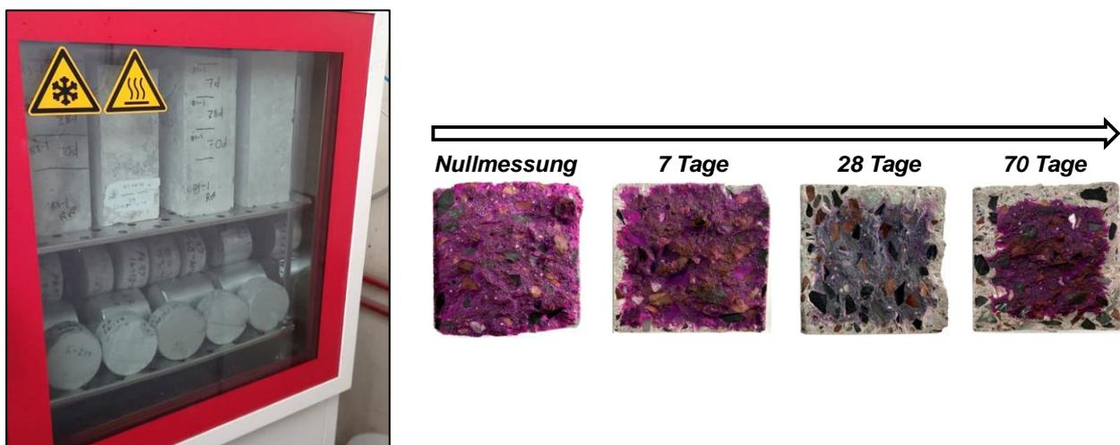
Abbildung 38: Lagerung von Proben (sowohl Prismen als auch Bauteilproben) in der CO<sub>2</sub>-Kammer unter beschleunigten Bedingungen (3,0 Vol.-% CO<sub>2</sub>) (links) und exemplarisch gemessene Karbonatisierungstiefen über 70 Tage (rechts)
