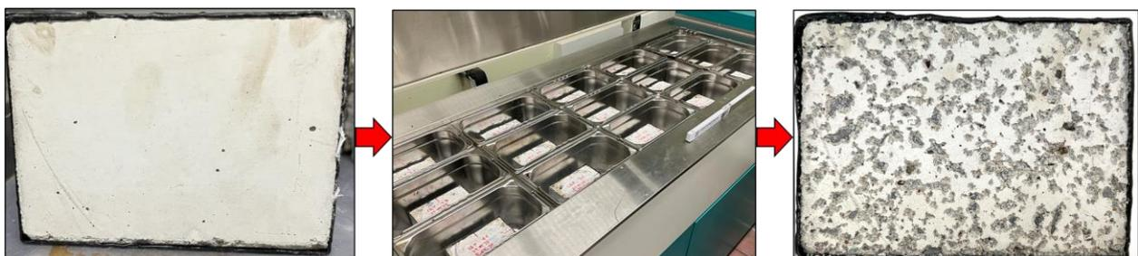
Abbildung 50: Aufnahme eines Probekörpers vor der CDF-Prüfung (links), in der CDF-Truhe (mittig) und nach der CDF-Prüfung (rechts)
