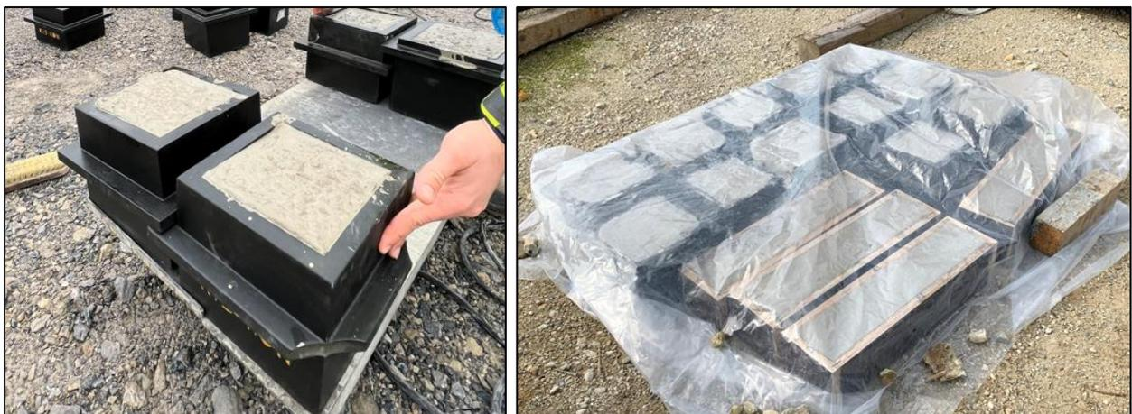
Abbildung 17: Verdichtung (links) und Folienabdeckung (rechts) der separat hergestellten Proben (SHP)
