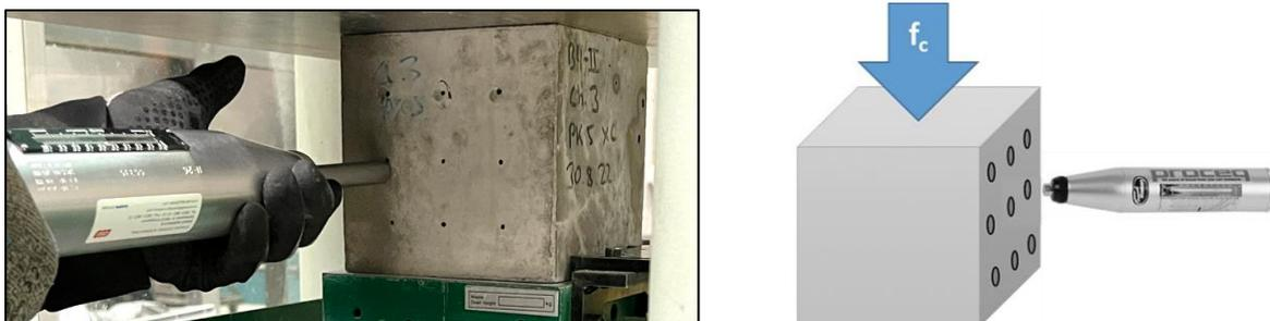
Abbildung 29: Bestimmung der Rückprallwerte an separat hergestellten Proben, nach [64, 65]
