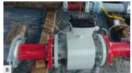
Schematische Darstellung der Pumpstrecke einschließlich der Drucksensoren S1-S8, Temperatursensoren T1-T3 und des Fördermessgerätes FM (4); reale Pumpstrecke (5), eingebaute Drucksensoren (6), Temperatursensoren (7) und Durchflussmessgerät (8).
