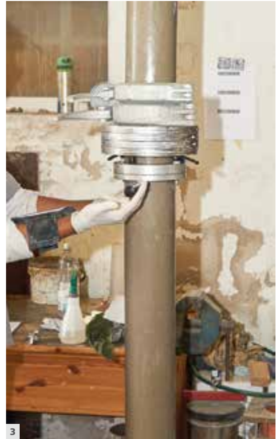
Rheologische Geräte: Viskosimeter (1), Tribometer (2) und Sliper (3).
