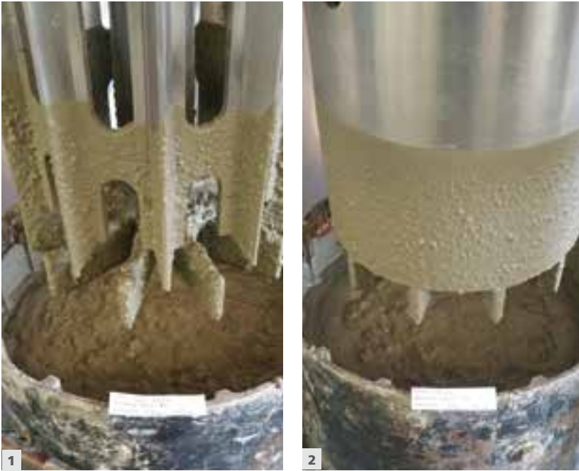
Rheologische Geräte: Viskosimeter (1), Tribometer (2) und Sliper (3).
